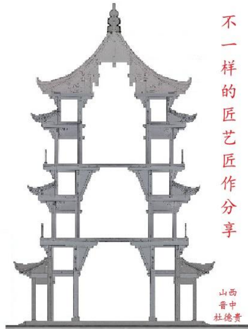
图2-0-35晋中文昌阁构架做法示意图
