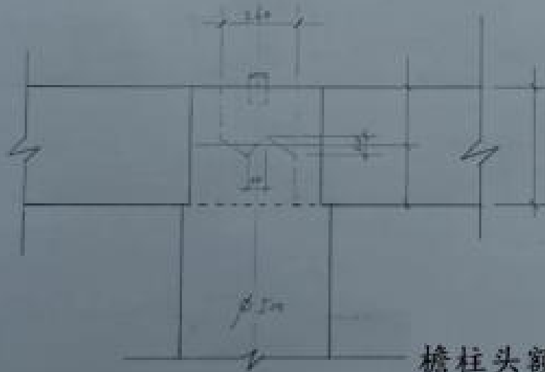
图2-0-4柱头额枋续接卯榫做法范例图
